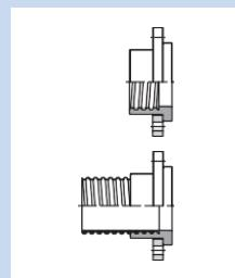
**Losflansch passend für Gegenflansche nach DIN 2632/2633, Lochbild DIN-EN 1092-1 (PN10, bis 16 bar – ab ø450 bis 10 bar); lebensmittelecht**
